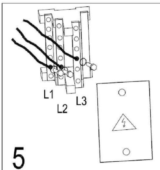
Рекомендуется действовать крайне осторожно, при затягивании винтов использовать шайбы, проверить правильность затяжки винтов, затем установить на место пластиковую защиту.
