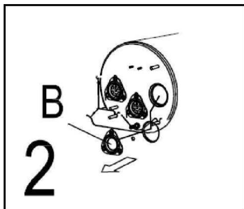
Затем установить дополнительный нагревательный элемент и вставить входящую в комплект прокладку в середине.
