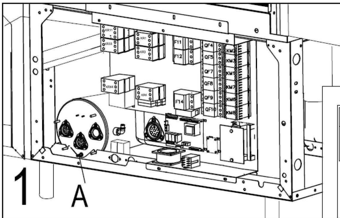
Опустошить бойлер и отключить подачу ополаскивателя через отверстие «А», временно отсоединив шланг или сняв крышку, после чего дождаться полного слива из бойлера. Установить шланг на место так же, как он был подключен изначально.
