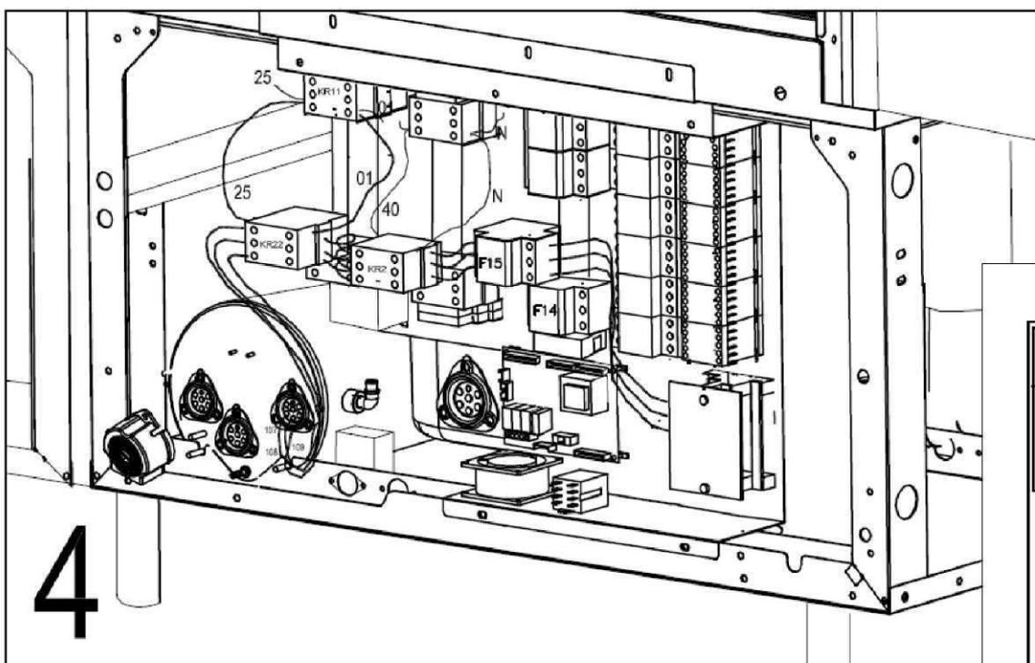
Проложить провода, как показано на схеме, затем подсоединить провода 107 - 108 - 109 к свободным контактам нагревательного элемента (см. сбоку). Подсоединить провода 40 и N к соответствующим номерам на расположенном рядом контакторе, который уже подключен, или использовать имеющиеся клеммы. Выполнить аналогичную операцию в отношении проводов номер 25 и 01. Как показано на рис. 4. Установить подходящую пластиковую защиту.
